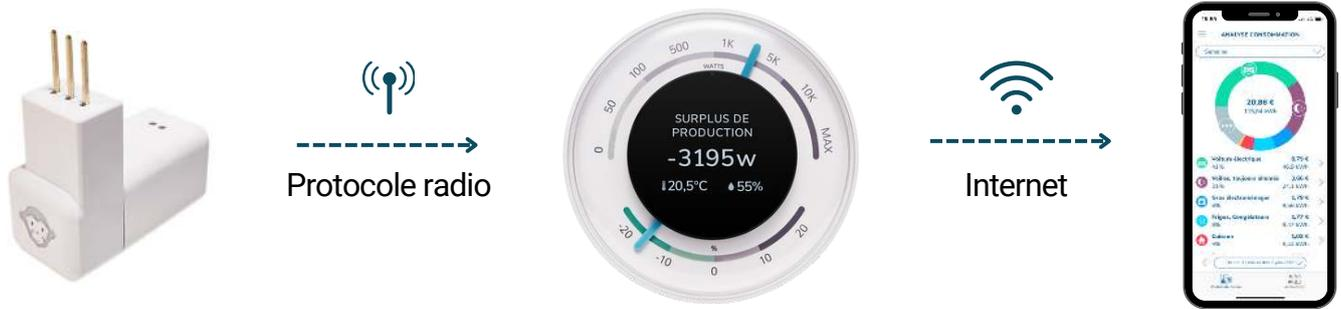
La clé Linky se branche sur le compteur Linky via le port TIC et effectue des relevés de la consommation en continu. Elle les transmet sans fil à l'assistant (protocole radio - portée de 50m) toutes les 5 à 10 secondes. L'afficheur s'installe dans une pièce à vivre et affiche les mesures en temps réel. L'assistant envoie ensuite les informations jusqu'à l'application, sur laquelle toutes les mesures de consommation sont disponibles.
